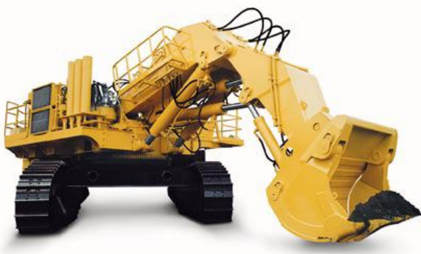
Рис. 3 ЭГ-110 серийно оснащается АЦСС Lincoln
