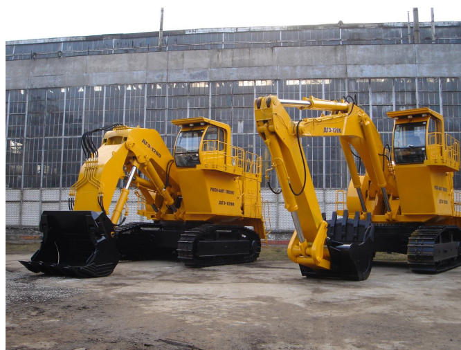
Рис.2 Экскаваторы ДГЭ-1200 с системами смазки Lincoln
