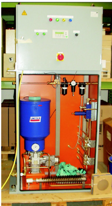
Рис.5 Насосная станция типа ZPU08 с блоком управления(слева) и панель с форсунками распыления(справа) для систем смазки мельниц
