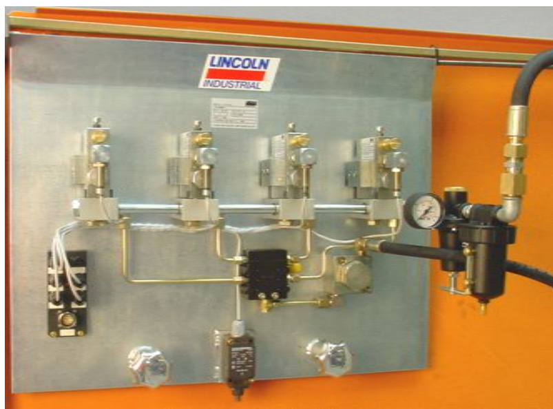
Рис.5 Насосная станция типа ZPU08 с блоком управления(слева) и панель с форсунками распыления(справа) для систем смазки мельниц
