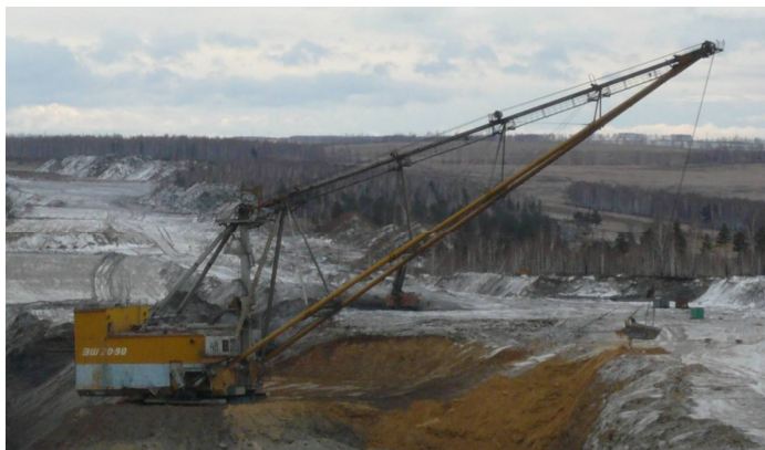
Рис.1 Экскаватор ЭШ 20.90 с системой смазки фирмы Lincoln ("Разрез Черемховский" ООО "Востсибуголь")
