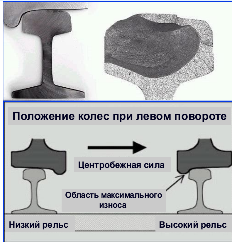
Рис 4.1. Взаимодействие колеса и рельса при левом повороте
