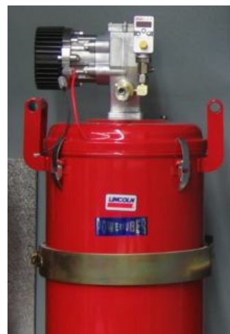
Насос тип FlowMaster 24V со стационарной ёмкостью 60 литров
