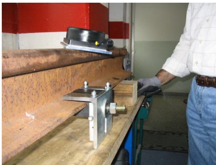
Установка крепления сенсорного датчика
