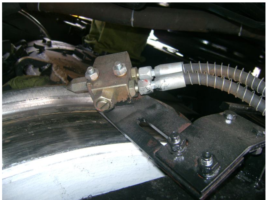
Пример установки форсунки тип SD на локомотиве
