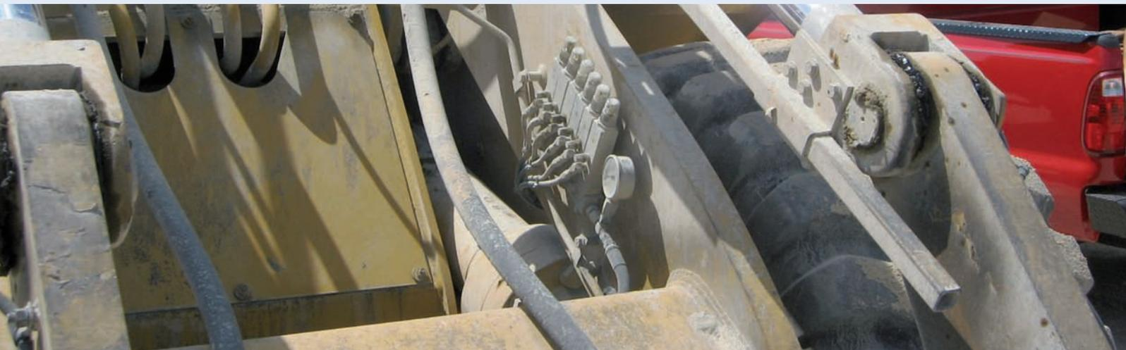
Машины, работающие в сложных условиях, нуждаются в постоянном смазывании для эффективной работы. Если подшипник или какой-то элемент выходит из строя по причине недостаточного смазывания, это означает простой и убыток. Однолинейные насосы 603S и 653S обеспечивают смазку точки трения автоматически и точно дозировано, с программируемым интервалом подачи и во время работы машины.
